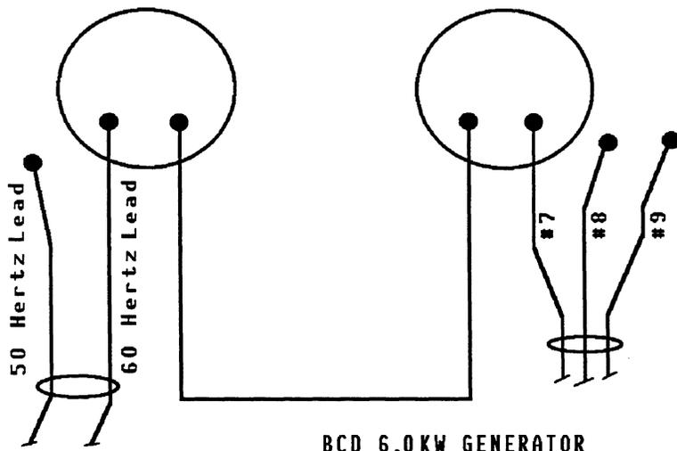
THE #7 PLUG IS SHOWN CONNECTED TO THE CAPACITOR ONLY FOR DEMONSTRATION PURPOSES.
